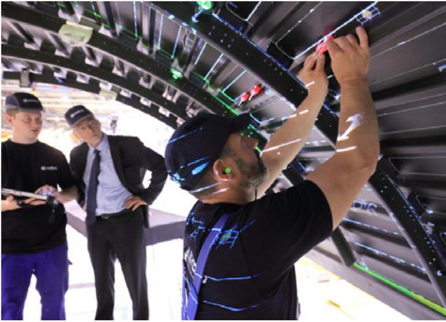
**КОРПОРАЦИЯ AIRBUS** с 2011 года внедряет Smart Augmented Reality Tool для контроля качества на своих производствах. Планшеты со специальными датчиками и программным обеспечением накладывают схемы прямо поверх реальных объектов, дают моментальный доступ к базам данных, содержащим всю необходимую информацию. К настоящему моменту более 1000 сотрудников Airbus используют Smart Augmented Reality Tool в своей работе.
