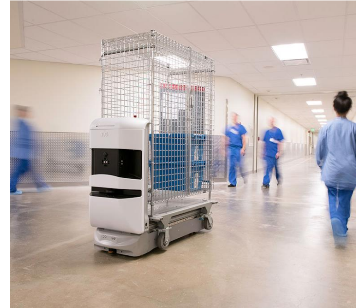
Tug, робот для доставки медикаментов и перевозки анализов в госпиталях
